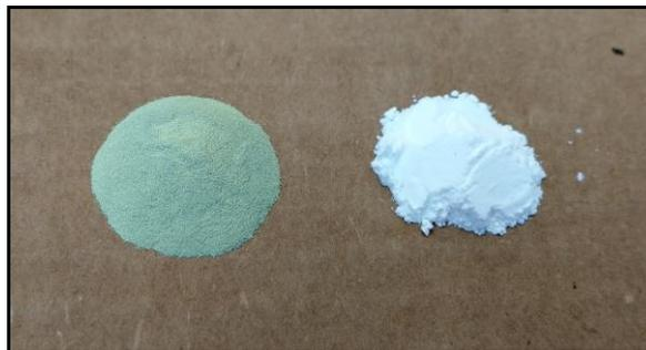
**Abbildung 14:** Fotografische Aufnahme der verwendeten kommerziellen Halbleiterpulver von  $\text{WO}_3$  und  $\text{TiO}_2$  P25/20. Das  $\text{WO}_3$ -Pulver hat eine grün-gelbe Farbe, während das  $\text{TiO}_2$  Pulver weiß ist.
