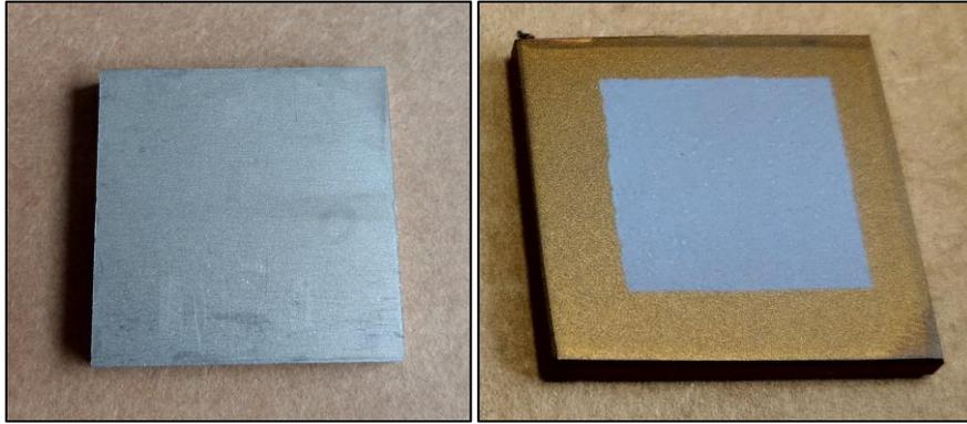
**Abbildung 75:** Zwei fotografische Aufnahmen von einem unbeschichtetem Titanmetall-Substrat vor dem Kaltgasspritzen (links) und von einer Siebdruck-TiO<sub>2</sub>/Ti-Photoelektrode (rechts). Die rechte Photoelektrode besteht aus einem Siebdruckfilm von TiO<sub>2</sub> auf Titanmetall als Substrat.
