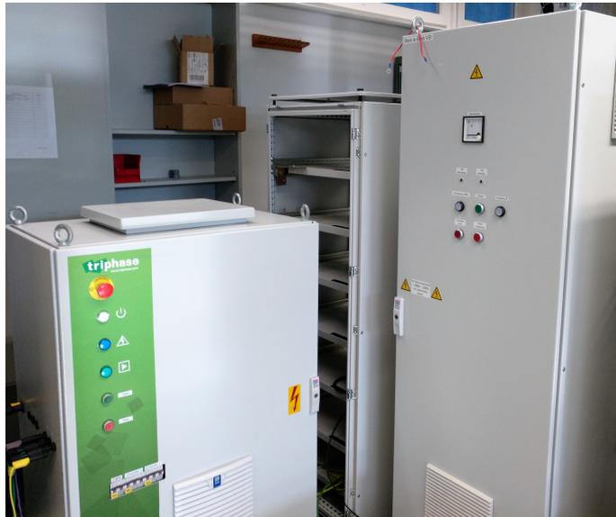
**Abbildung A.7:** Foto des Versuchsaufbaus zur Untersuchung der Antriebsstrangtopologien (links: Triphase System zur Realisierung der gesteuerten Last, rechts: Prüfling)
