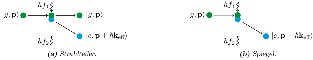
Abb. 2.5: Elemente eines Atominterferometers mit Atomen im Grundzustand |g\rangle in grün und im angeregten Zustand |e\rangle in blau eingezeichnet (nach Schilling et al., 2012). Für Atome im angeregten Zustand |e\rangle gelten die Abbildungen sinngemäß.
