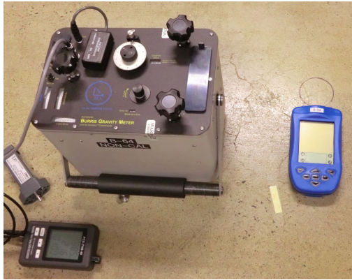
(a) ZLS Burris B-64 mit Handheld PDA zur Bedienung des Instruments.
