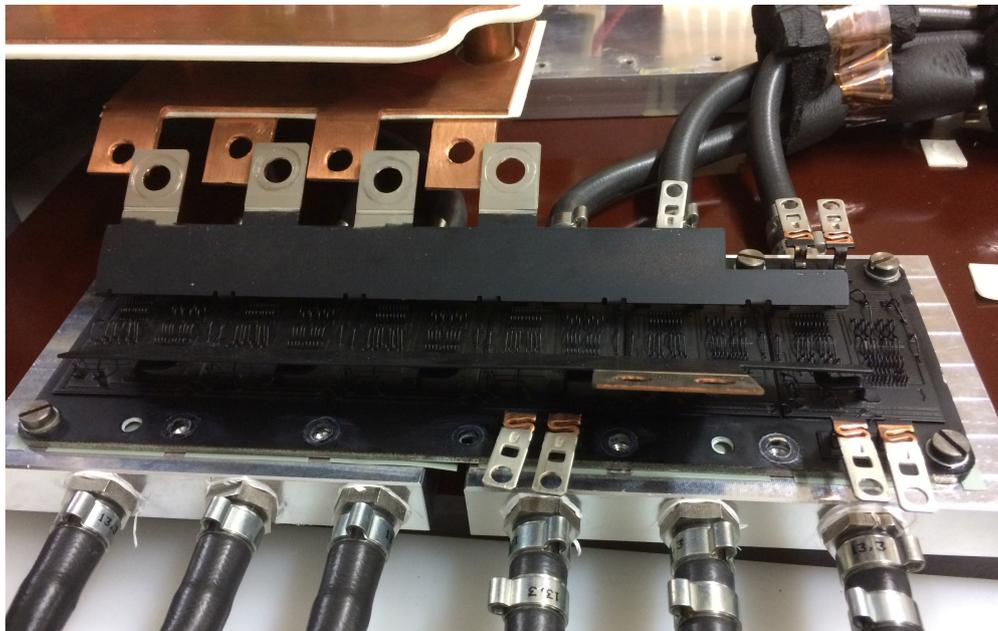
Abbildung 5.12: Geöffnetes IGBT-Modul auf getrenntem Kühlkörper
