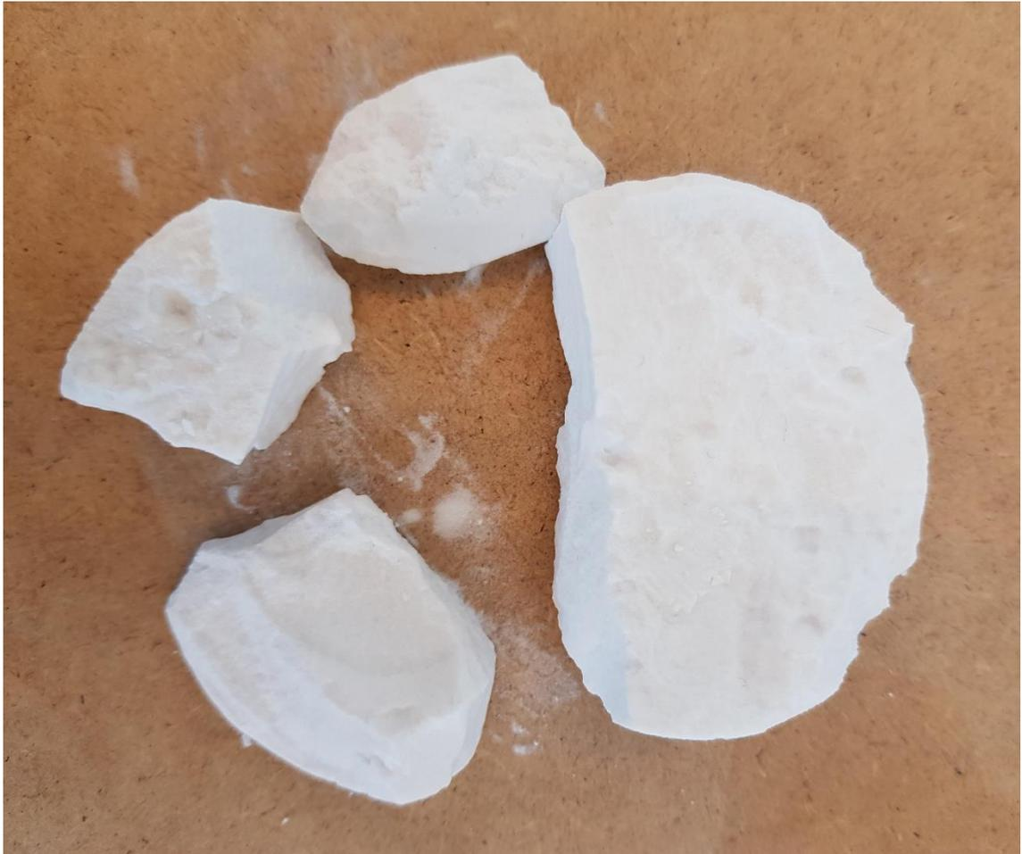
**Abbildung 87: Fotoaufnahme der verklebten Glaskugelschüttungen infolge der Hydrophobierung des Wirkstoffgehaltes 100 % nach den Wasserransportversuchen**
