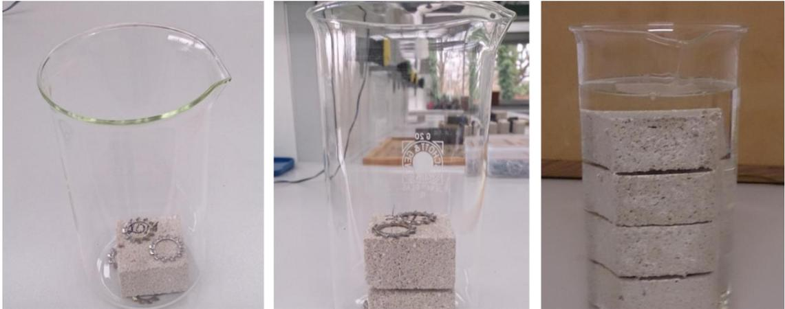
**Abbildung 19: Imprägnieren der Prüfkörper mit Hydrophobierungsmittel. Links: Prüfkörper im Becherglas mit Zahnscheiben als Unterlage. Mitte: gestapelte Prüfkörper mit Zahnscheiben als Zwischenlage. Rechts: gestapelte Prüfkörper mit Hydrophobierungsmittel**
