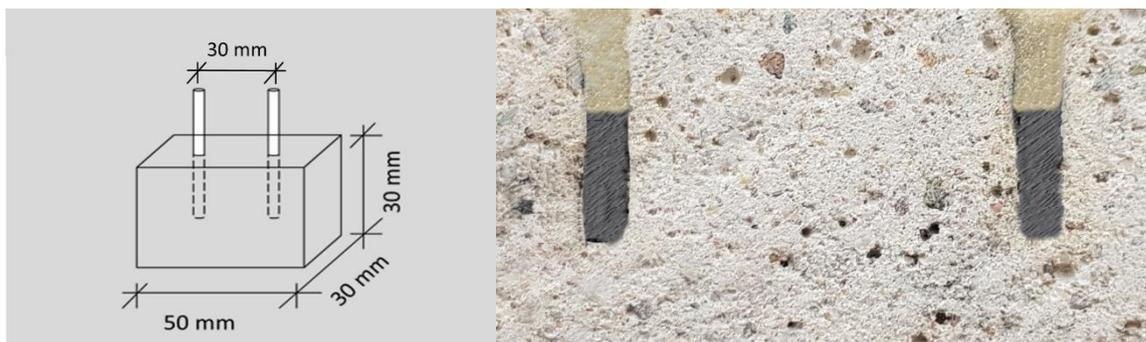
**Abbildung 21: Schematische Darstellung Prüfkörperaufbau (links). Füllung der Bohrlöcher eines Prüfkörpers aus Mörtel mit leitfähigem und darüber befindlichem, isolierendem Klebstoff; vertikaler Sägeschnitt (rechts).**
