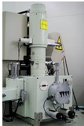
Abb. 28: Rasterelektronenmikroskop (JEOL - JSM-6400F)
