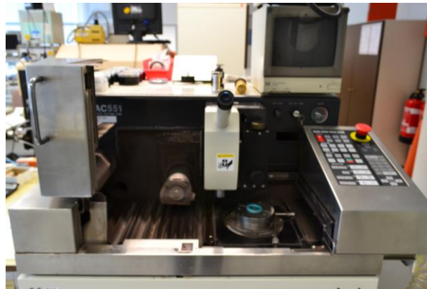
Abb. 18: Am IMPT zur Verfügung stehende Trennschleifmaschine (DISCO - DAC551)
