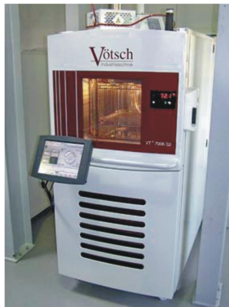
Abb. 30: Angewandte Thermoschockkammer (VÖTSCH – TEMPERATUR- UND KLIMAPRÜFANLAGE DER SERIE VT 3 )
