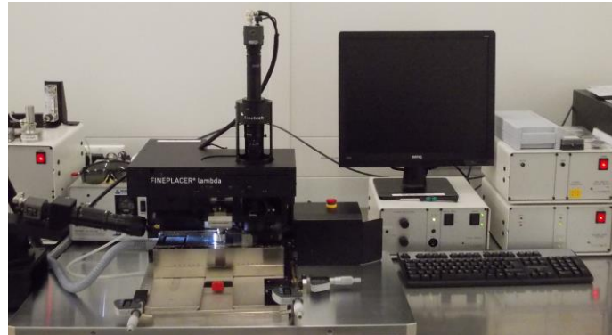
Abb. 21: Am IMPT vorhandener Flip-Chip-Bonder (FINETECH - FINEPLACER ® LAMBDA)
