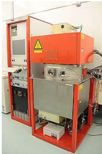
Abb. 15: Am IMPT zur Verfügung stehende Sputteranlage (SENVAC)
