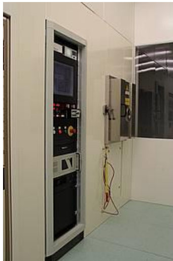
Abb. 17: Am IMPT vorhandene Aufdampfanlage (LAB500PLUS - LEYBOLD)
