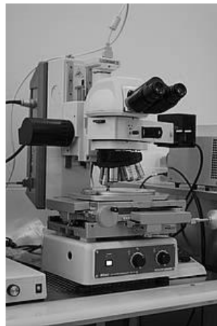
Abb. 27: Messmikroskop (NIKON - MM-400)
