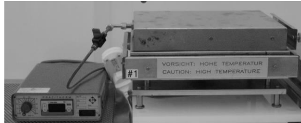
Abb. 19: Am IMPT vorhandener Ofen (LHG PRÄZITHERM - 2860 SR)
