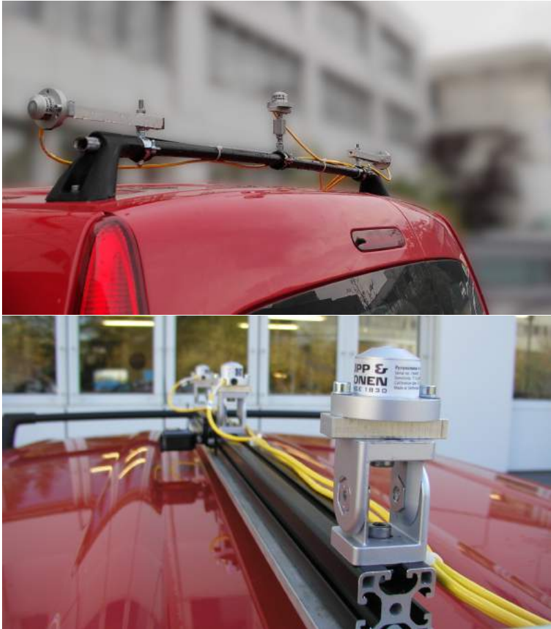
Abbildung 3.1: Messaufbau zur Einstrahlungsmessung auf dem Fahrzeug. Die Messung erfolgt jeweils mit drei Pyranometern, die Datenaufzeichnung über ein Laptop mit USB-Oszilloskop (nicht gezeigt). Oben: Messkonfiguration A mit einem vertikal ausgerichteten Pyranometer in der Mitte zur Messung der Sonneneinstrahlung auf dem Dach und jeweils einem horizontal nach links und rechts in Fahrtrichtung ausgerichteten Pyranometer zur Messung der Sonneneinstrahlung auf den Fahrzeugseiten. Unten: Messkonfiguration B mit drei vertikal ausgerichteten, in Fahrtrichtung hintereinander angeordneten Pyranometern. Diese Konfiguration erlaubt die Untersuchung der transienten Teilverschattung des Fahrzeugdachs während der Fahrt.
