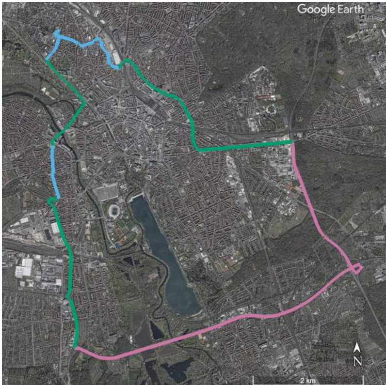
Abbildung 4.1: Satellitenbild mit eingezeichneter Testroute. Der Start- und Zielpunkt der Strecke liegt im Nordwesten, die Fahrtrichtung ist gegen den Uhrzeigersinn. Die Strecke ist in verschiedenen Teilabschnitten gegliedert, die in drei Straßenkategorien eingeteilt sind. „Schmale Straßen“ mit einer Geschwindigkeitsbegrenzung von 30 km/h sind in der Abbildung blau gekennzeichnet, „breite Straßen“ mit einer Geschwindigkeitsbegrenzung von 50 km/h grün und „Schnellstraßen“ mit einer Geschwindigkeitsbegrenzung von 80 km/h rosa.
