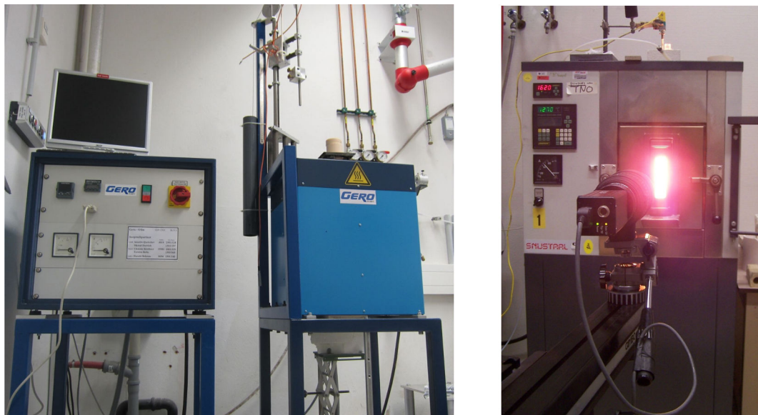
Abbildung 3.11: Links: Vertikalofen des Instituts für Mineralogie der Universität Hannover. Rechts: Kammerofen des TNO in Eindhoven mit Saphirfenster zur in situ - Beobachtung, davor ist eine Kamera mit UV- und IR-Filter positioniert, die alle 2s ein Foto aufnimmt.
