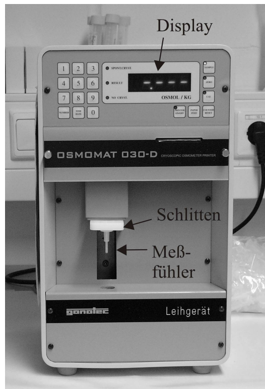
Abb. 10.2: Osmometer zur Bestimmung der Osmolalität von Frierschutzmitteln.
