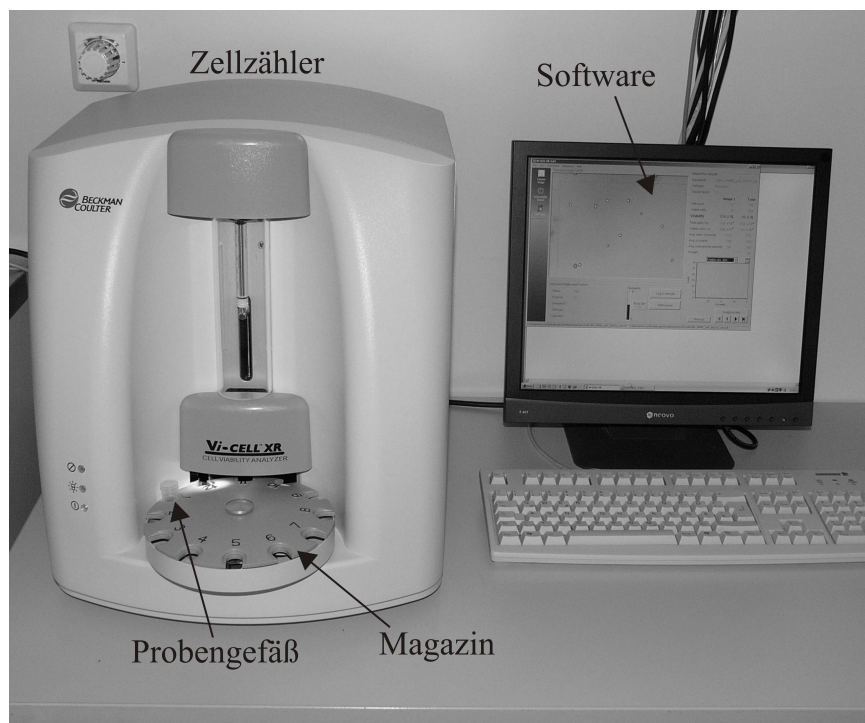
Abb. 10.5: Zellzähler-Messplatz zur Bestimmung der Membran-Integrität mittels Trypanblau-Färbung: Aus einem Magazin wurden automatisch bis zu 12 Proben sequenziell verarbeitet und mit einer Software ausgewertet.
