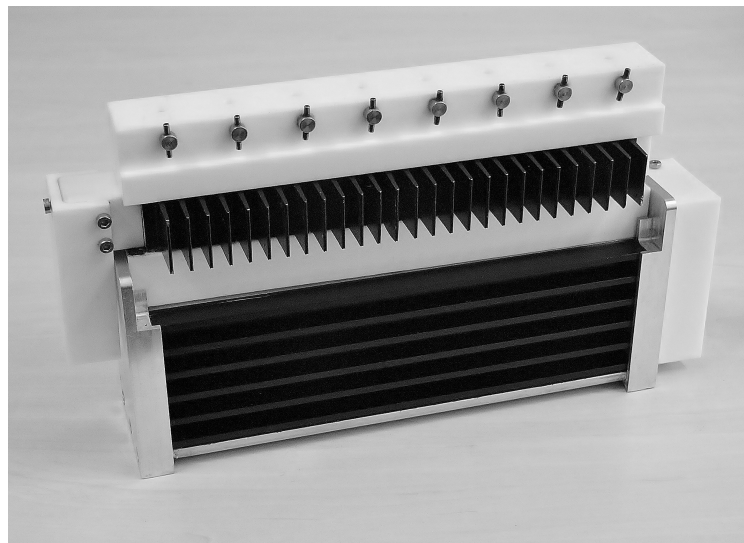
Abb. 5.8: Peltier-Element-basierter Frierblock zur Nukleation von acht parallelen 1 mL Proben in Kryoröhrchen. Nicht dargestellt ist der Deckel für die Kammerleiste (vgl. Abb 5.7).
