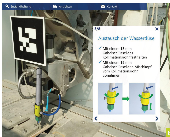
Abbildung 6 AR-Anwendung auf einem Tablet zum Austausch der Wasserdüse mittels ARViewer [5] [6]
