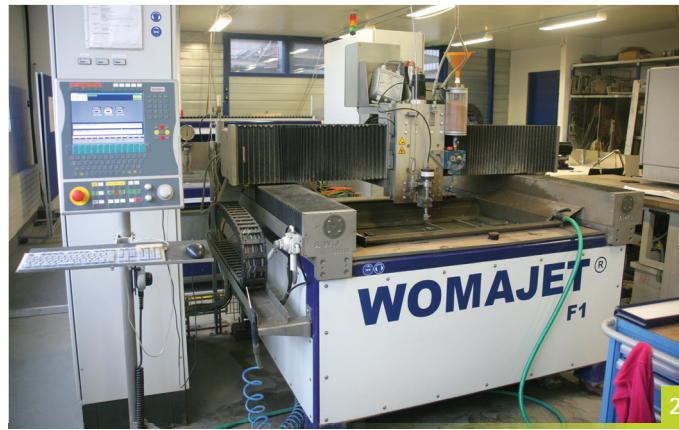
Abbildung 2 Die allererste Microwasserstrahlschneidmaschine WOMAJET Typ F1 ist auch heute noch im Einsatz
