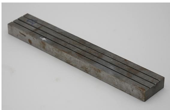
**(a)** längs geschlitzter Prüfkörper
