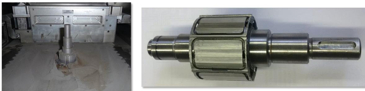
**Abbildung 2.12:** Additiv gefertigte Rotorwelle aus FeSi<sub>2,9</sub> Gen.1 WB aus [28] bzw. [79]
