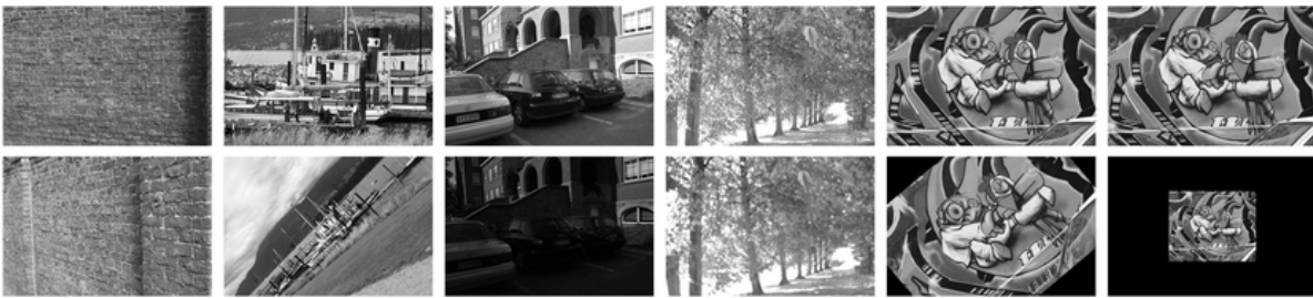
Abbildung 3.22: Verwendete Testbilder mit Störeffekten aus dem Oxford Datensatz. Von links nach rechts: wall (Blickpunkt), boat (Zoom und Rotation), leuven (Belichtung), trees (Blur), graffitiRotation (Rotation), graffitiScale (Skalierung) [Mik05a]
