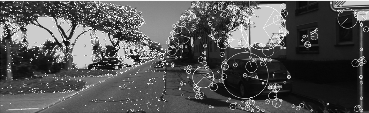
Abbildung 2.3: Bildmerkmalsextraktion: FAST-Eckendetektor nach [Ros10] (links), SIFT-Blob-Detektor mit Skalierung und Orientierung nach [Low04b] (rechts). Beispielbild aus der KITTI Vision Benchmark Suite [Gei13].
