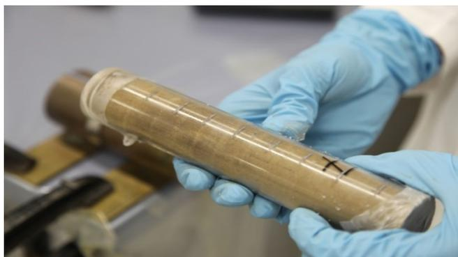
**Abbildung 23** – Tiefgefrorener Bohrkern. Die Endkappen wurden entfernt und zum Sägen durch Parafilm ersetzt.
