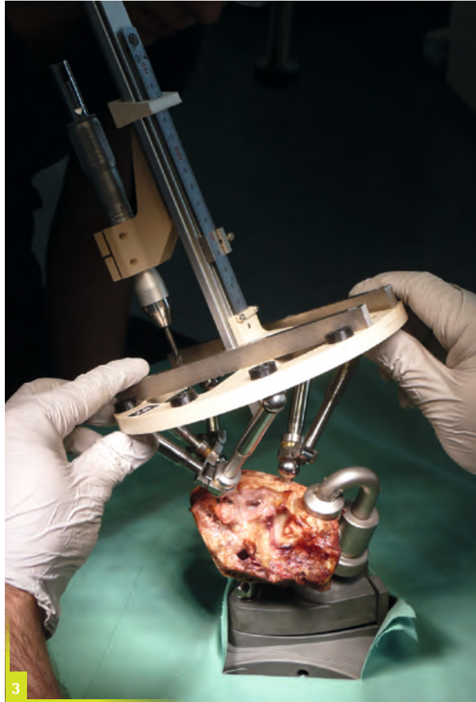
Abbildung 4 Schablone mit individualisierter Bohrerführung am Phantom. Fotos: Institut für Mechatronische Systeme
