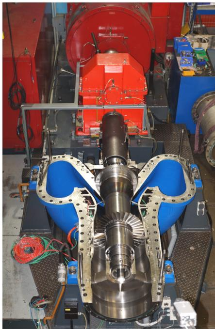
Abbildung 5.1: Unterteil des Turbinengehäuses mit Innengehäuse und Rotor
