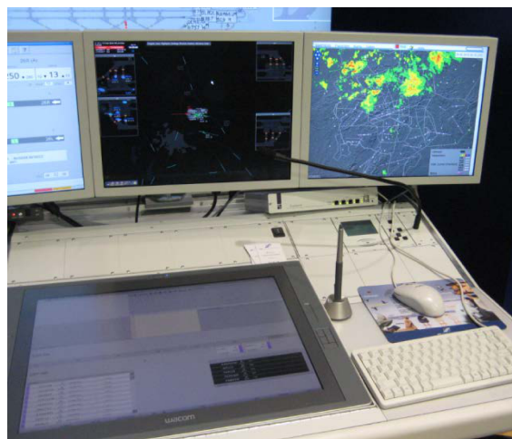
Abbildung 2.12: Darstellung meteorologischer Informationen auf einem MetFROG-Monitor der DFS (rechts im Bild). Quelle: [43].
