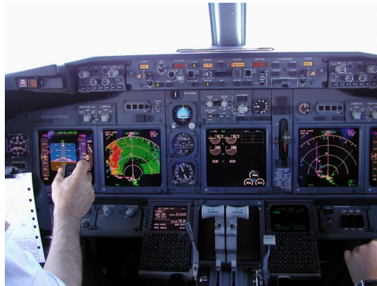
Abbildung 2.9: Cockpit einer Boeing 737-8Z9. Das Bordwetterradar ist auf dem zweiten Monitor von links zu sehen. Quelle: [34].
