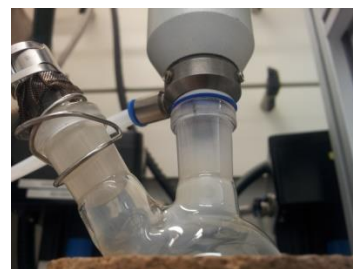
Abbildung 29: Atmosphärendruckplasmavermittelte Silikatisierung von Stahlkugeln (oben), statische Düse für einen Ionenstrom von 3000 L h -1 mit Precursor -Zustrom (links unten), Reaktor für die Behandlung der Stahlkugeln mit Plasma (rechts unten).
