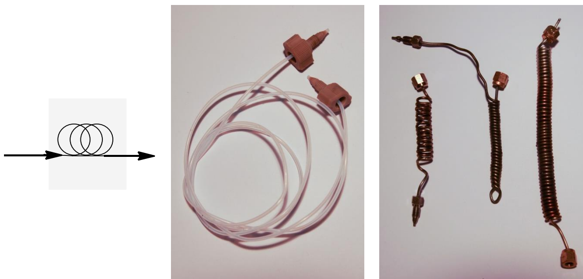
Abbildung 9: Fließsymbol Wickelreaktor (links), Wickelreaktor aus PTFE (ID= 1 mm) mit Verschraubungen (mitte), Wickelreaktoren aus Edelstahl (ID= 1 mm) mit Verschraubungen (rechts).
