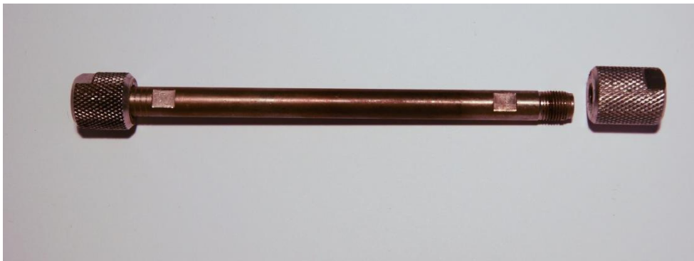
Abbildung 8: Kartuschenreaktor aus Edelstahl (AD= 10mm, ID= 8 mm, l= 120 mm).
