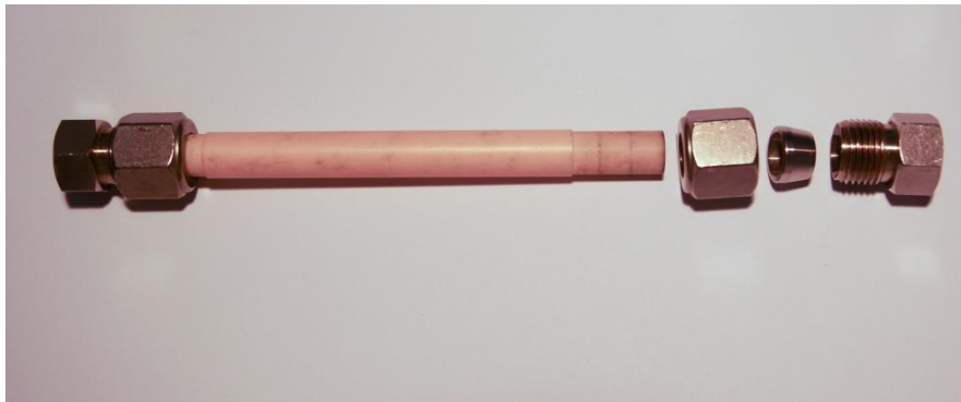
Abbildung 7: Kartuschenreaktor aus Keramik (AD= 10mm, ID= 6 mm, l= 120 mm).
