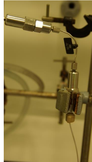
Schema 5: Fließschema Hochtemperaturdurchflussanlage (oben), Druckreaktor (Heizzone= 50 mm, ID= 4 mm, V = 0.4 mL) (unten links), Wärmetauscher ( V = 0.5 mL), Rückdruckventil (zwei in Reihe installiert, 120 bar) (unten rechts).
