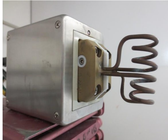
Abbildung 14: Schematische Darstellung eines Schwingkreises (links) und verwendeter Hochfrequenzinduktor (rechts).
