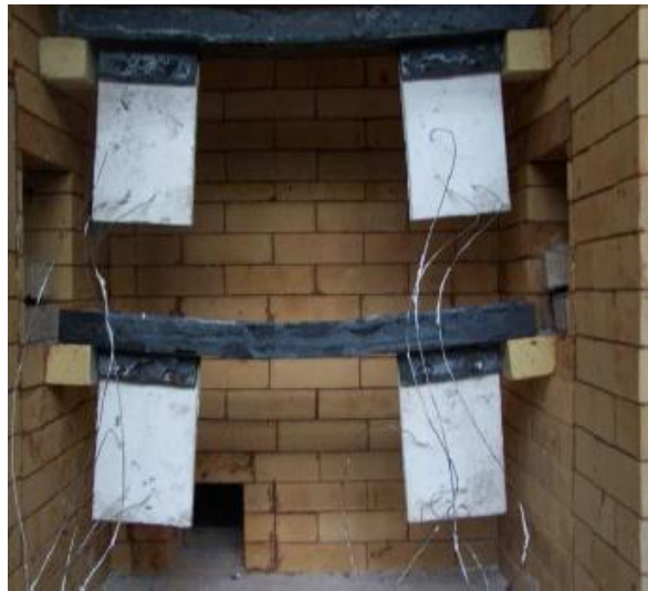
Abbildung 2.12: Versuchsaufbau in Zhang [85] zur Ermittlung der thermischen Eigenschaften von DSB
