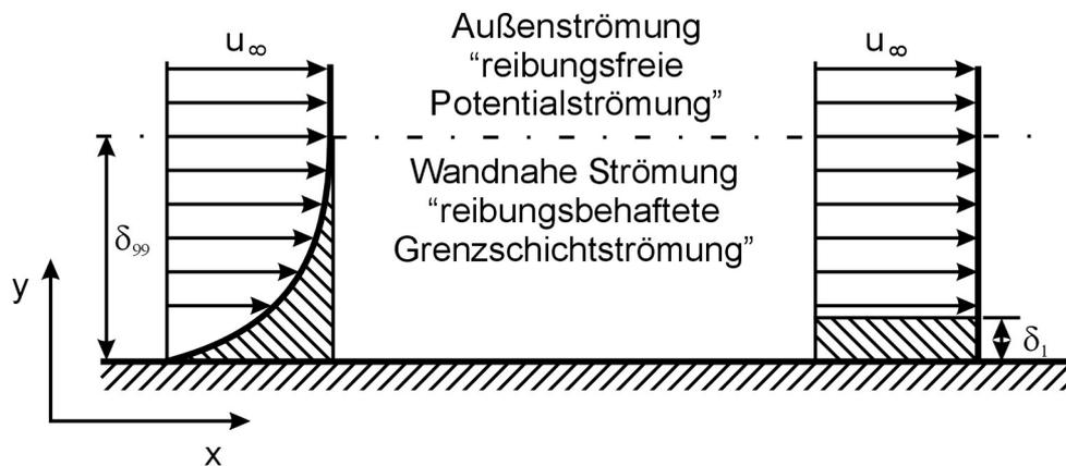
Abbildung 2.5: Grenzschichtströmung und Verdrängungsdicke  $\delta_1$  nach Merker und Baumgarten (2000)
