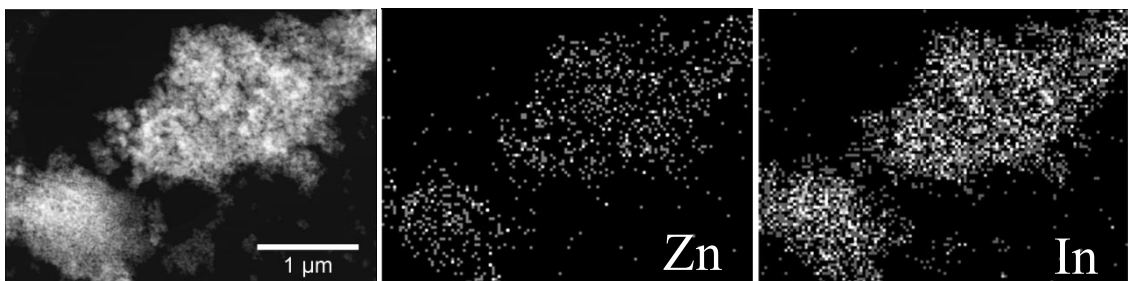
Abbildung 4-69. STEM-Dunkelfeld-Abbildung eines Agglomerats der Nanopartikel, die bei der Abscheidung mit 5 at.% Indiumionen in der Abscheidungslösung erhalten wurden, und die dazugehörige Zink- und Indium-Elementverteilung aus der EDXS-Analyse.
