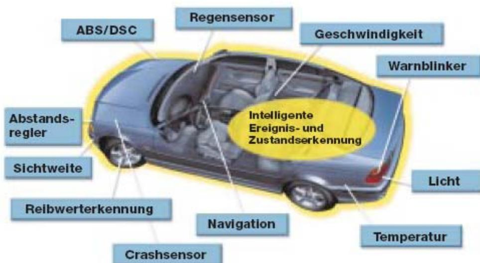
Abbildung 1: Beispielhafte Fahrzeugsensorik [BMW99]
