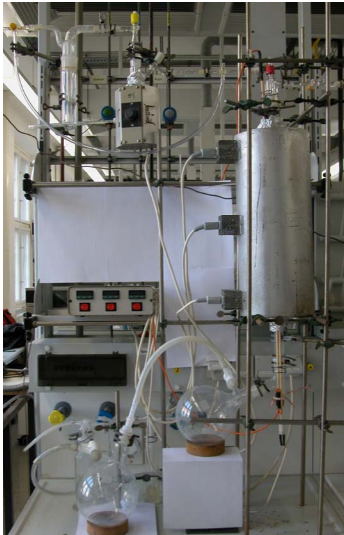
Abb. 3-2. Apparatur für die Umsetzung flüssiger Precursor mit Sauerstoff.
