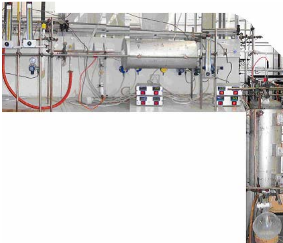
Abb. 3-5. Apparatur zur Darstellung von dotiertem SnO 2 .
