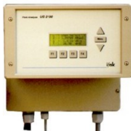
Abbildung 3-2: Kontrolleinheit des Ultraschallsensorsystems
