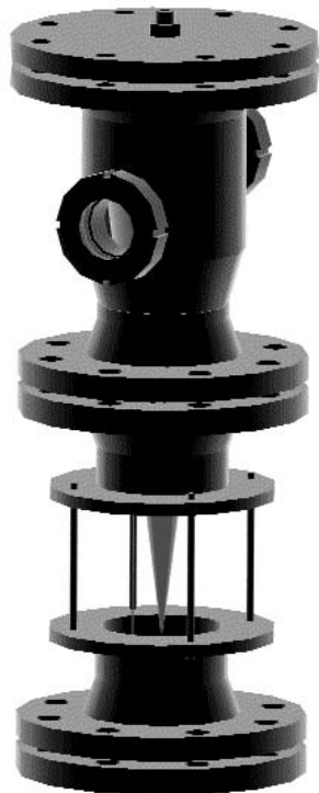
Bild 8.15 : Ansicht des Druckbehälters
