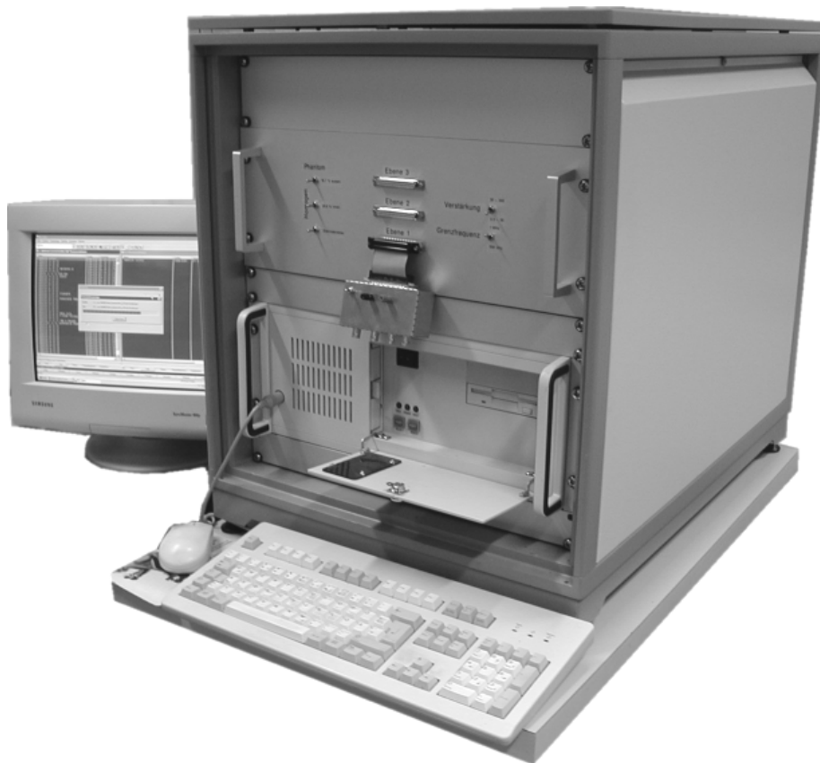
Abb. 10.4: Einsatzfähiges Bioimpedanz System mit Aufsatz für die Impedanzspektroskopie.
