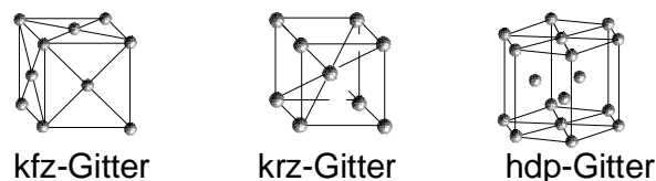
Bild 2-1: Grundgitter der häufigsten Metalle
