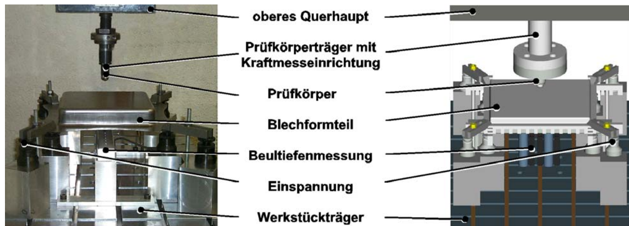
Bild 7-4: Beulprüfstand für quasi-statische Belastung, Punktlast
