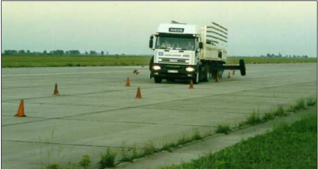
Abbildung 7: Einfacher Fahrspurwechsel, pfadfolgende Methode
