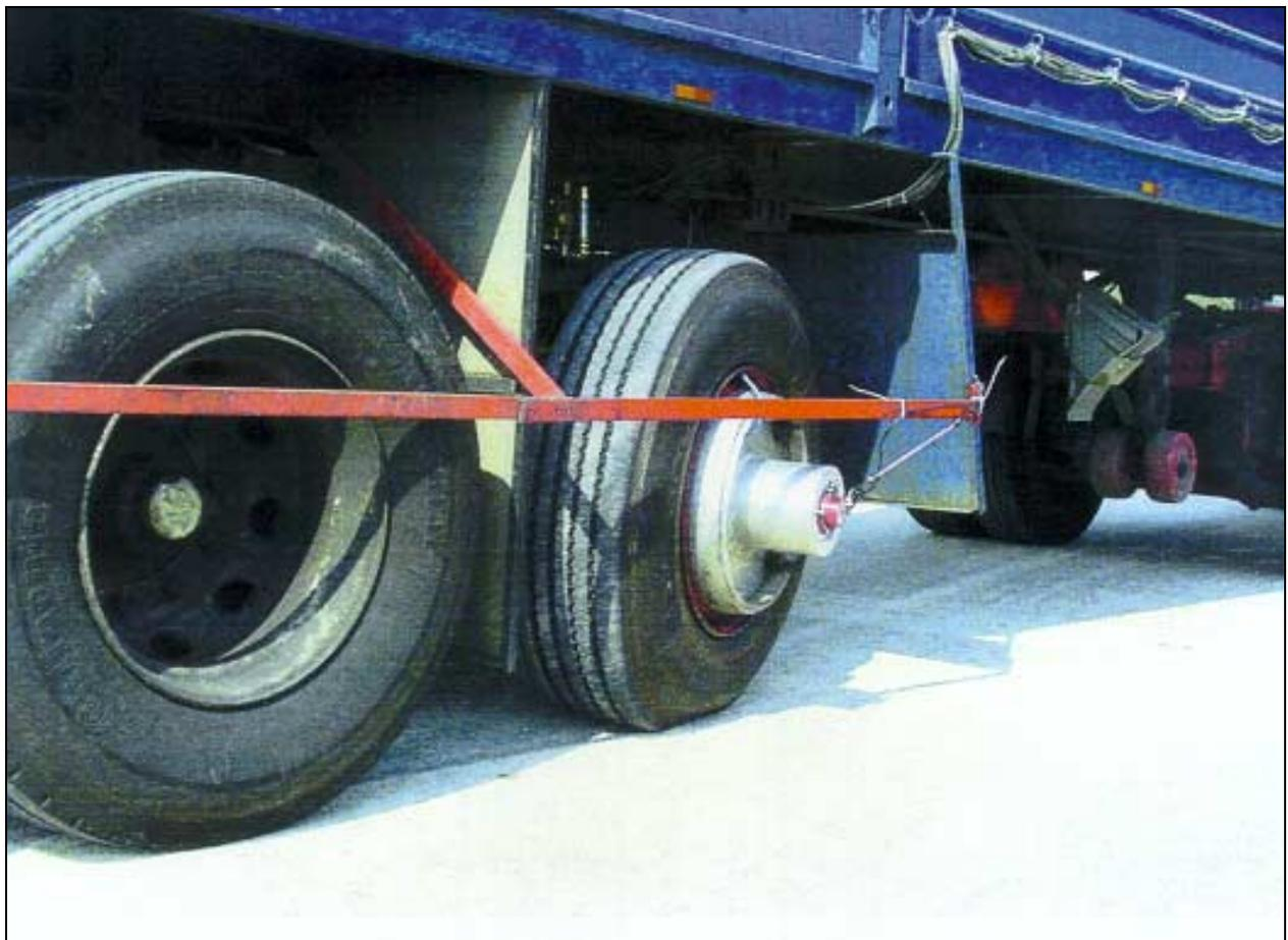
Abbildung 18: Meßachse im Betrieb, Schräglaufmessung
