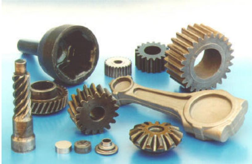
Bild 1-3: An IFUM und IPH präzisionsgeschmiedete Bauteile
