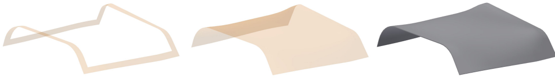
Abbildung 5.21: Erzeugungsprozess des Blechbasiselementes
