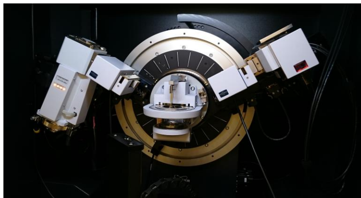
Abbildung 25 Abbildung des Röntgen-Pulverdiffraktometers Bruker D8 Advance
