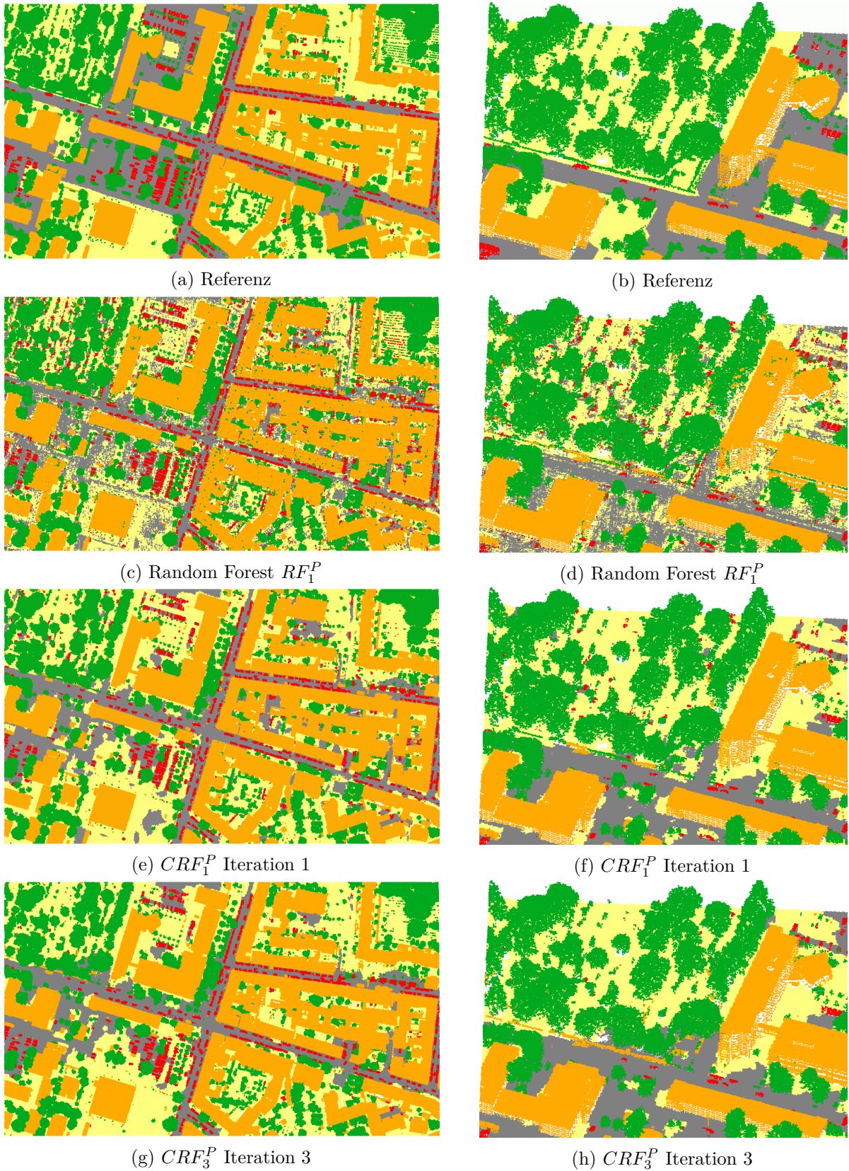
Abbildung 5.12: Klassifikationsergebnis Hannover. Die linke Spalte zeigt das gesamte Testgebiet; in der rechten Spalte ist der nord-westliche Ausschnitt detaillierter visualisiert. Unterschieden werden die fünf Klassen Boden (gelb), Straße (grau), Auto (rot), Vegetation (grün) und Gebäude (orange).
