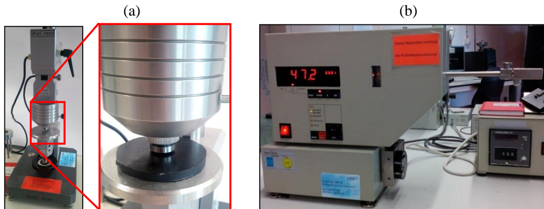
Abbildung 77: Härteprüfgerät „digitest“ der Firma Zwick GmbH & Co. KG (a) und Messapparatur (Zwick 5109.01) für die Rückprallelastizität (b).
