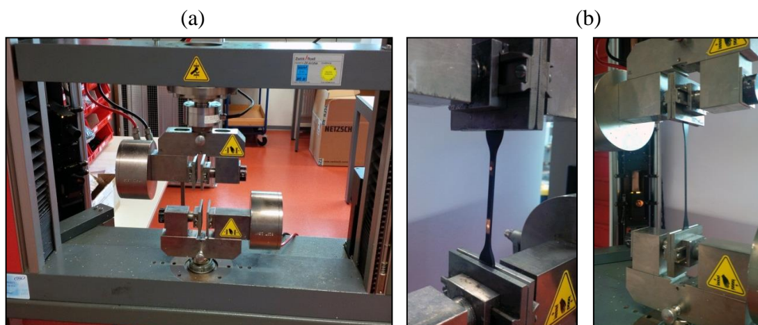
Abbildung 78: Darstellung der Zugapparatur Zwick Z010 (a) und ein Zugversuch mit einem eingespannten Probekörper (b), dessen Länge durch ein optisches System registriert wird.
