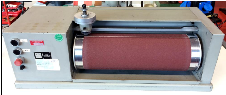
Abbildung 79: Die Abriebeigenschaften der Gummiprüfproben wurden mittels der Abriebapparatur von Frank bestimmt.
