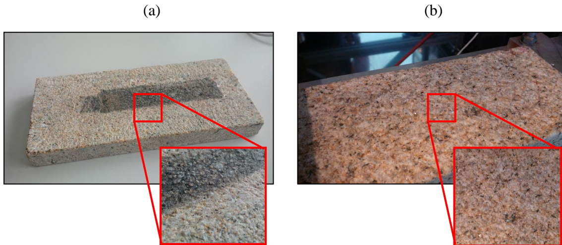
Abbildung 69: Gezeigt sind zwei Granitoberflächen, die für Reibversuche mit Laufflächenmischungen eingesetzt wurden. Der Granit B (a) weist eine feinere Oberfläche im Vergleich zu Granit C (b) auf.
