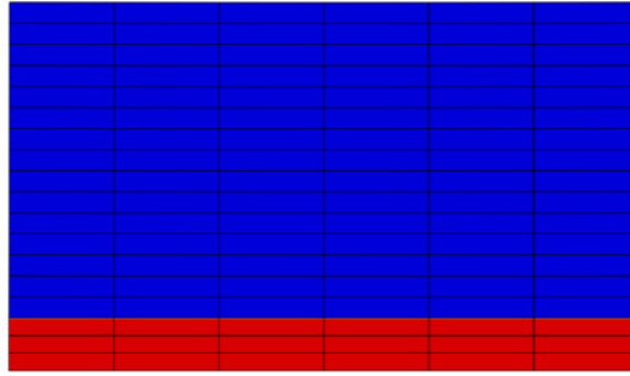
Abbildung 4.12: Numerisches Modell der experimentellen Untersuchung mit Stahlplatte (rot) und Holzmanschette (blau) in ABAQUS [1]
