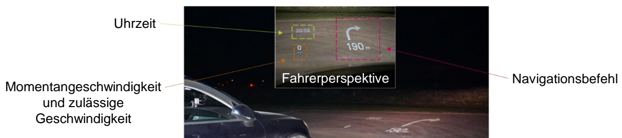
Abb. 3: Darstellung der Straßenprojektion mit eingeschaltetem Abblendlicht auf trockenem Asphalt
