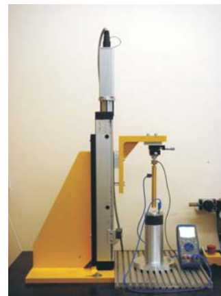
Abbildung 3.5: Prinzipskizze und Foto des Dichtungsprüfstands
