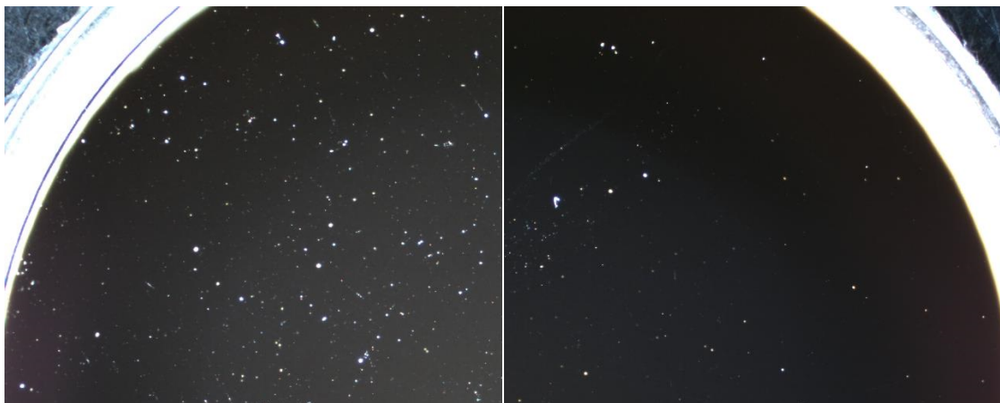
Abbildung 3.20: Dunkelfeldmikroskopie der ultravioletten Laserkomponente. Unter Zuhilfenahme der binären Materialkombination sollen Störsignale vermieden werden. Die Streueigenschaften ließen sich mit Hilfe einer indirekten Weißlichtquelle mikroskopieren. Im Vergleich zur Referenzprobe links konnte die Transparenz der binären Materialkombination rechts gesteigert werden.
