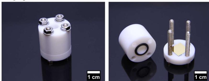
Abbildung 3.10: Fotografische Aufnahme der eigens konstruierten Teflonhalterung zur Beschichtung von Goldsubstraten mit L1CAM.
