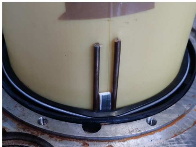
Abbildung 6.19: Führung der Glasfaser aus dem Re-SIST + -Behälter durch den Dichtungsring
