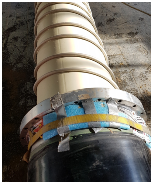
Abbildung 7.2: Bild des Innenrohrs mit spiralförmiger Temperierleitung und des Außenrohrs mit HDPE-Ummantelung
