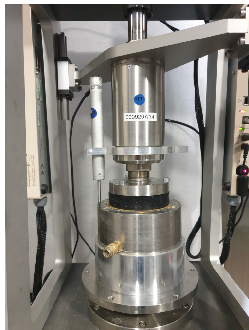
(b) RIST mit Probenzelle und Stempel
