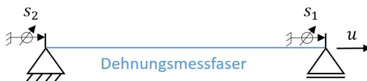
Abbildung 3.4: Schematische Darstellung des Faserkalibrierstandes
