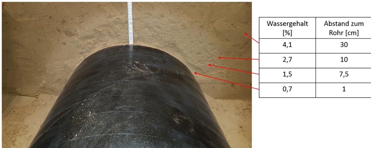
Abbildung 7.20: Bild vom Rückbau des Sandes SE mit Darstellung des Wassergehalts in Abhängigkeit des Abstands zum Rohr nach Versuchsende
