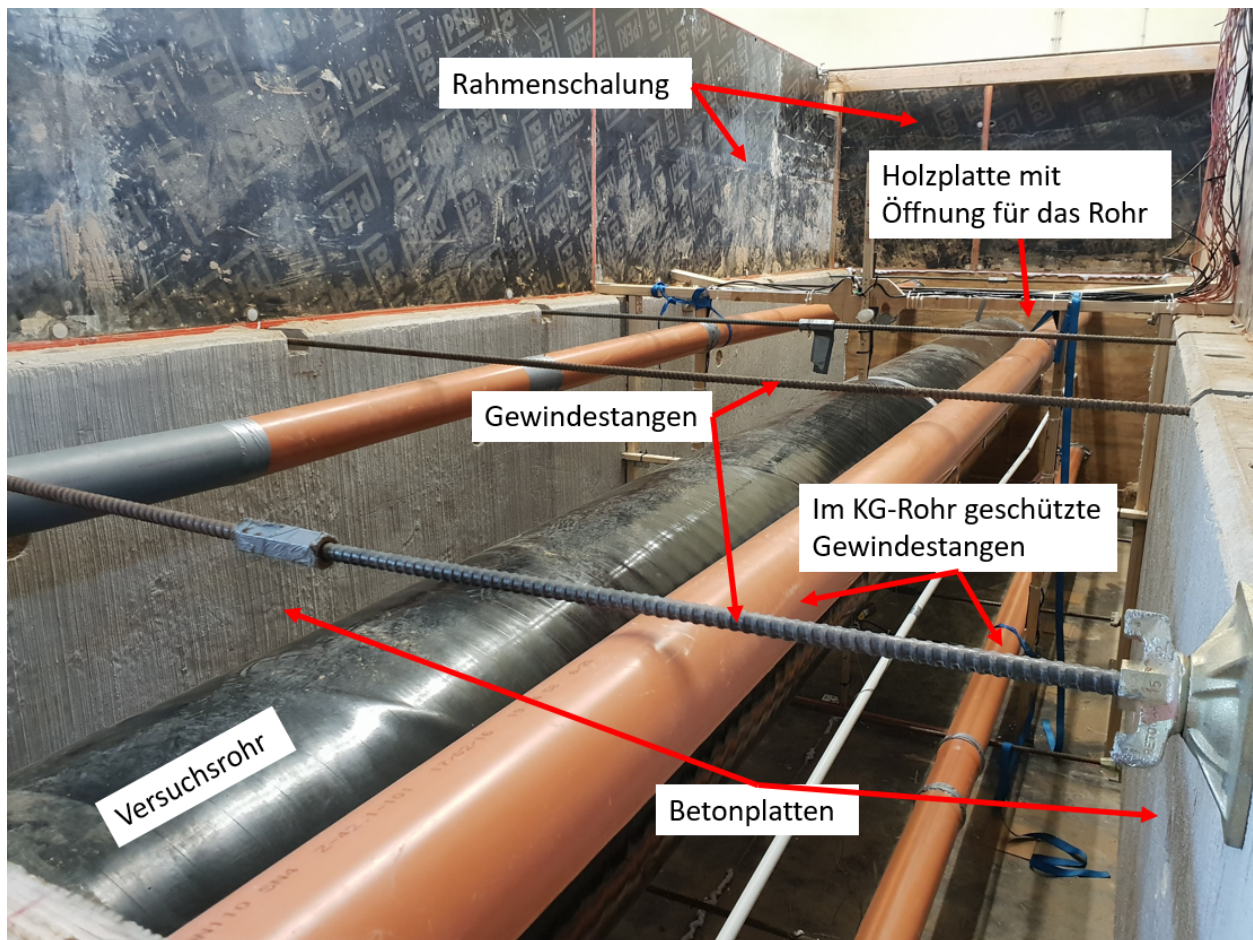
Abbildung 7.7: Versuchsstand vor ZFSV-Verfüllung, Ansicht innen
