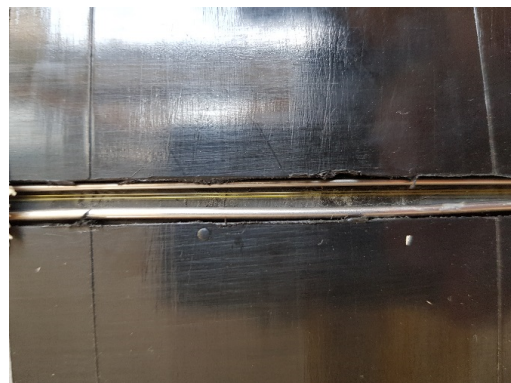
(b) Einlegen der faseroptischen Sensoren
