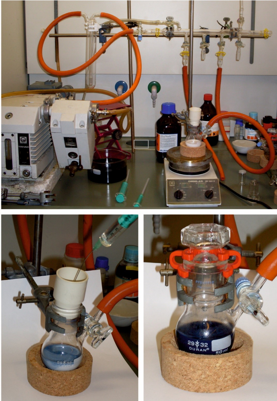
Abb. 5.2.3: oben Versuchsaufbau der chemischen Interkalation. Während der Lithium-Interkalation änderte sich die Farbe der Reaktionsmischung von weiß ( oben ) über hellblau ( unten links ) nach dunkelblau ( unten rechts ).
